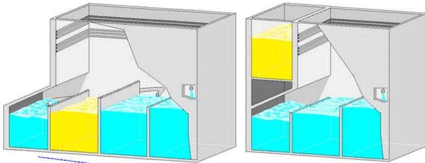
Schemi di impianti a detergente con asciugatura ad aria
